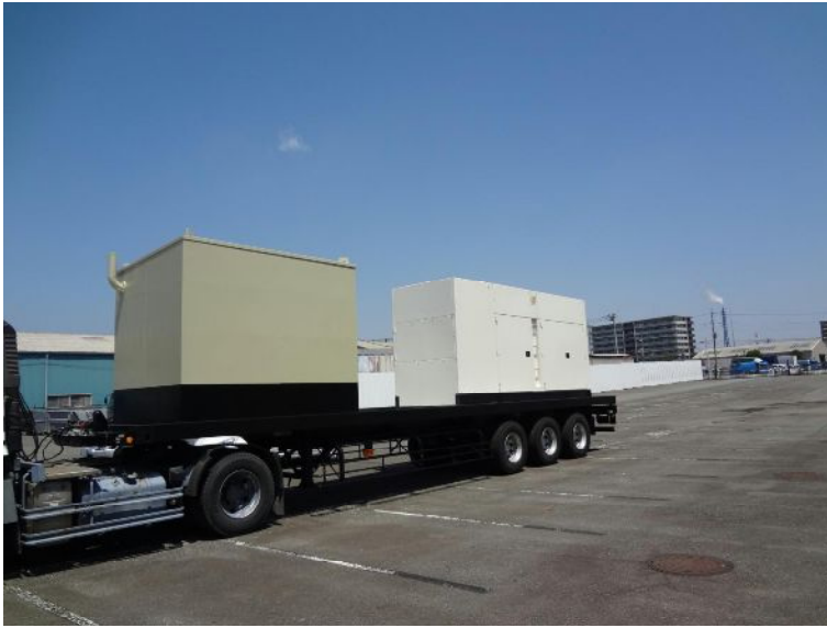
①トレーラー前方に油庫・後方に発電設備
